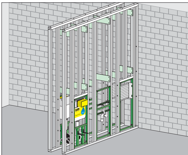
Двустороннее заполнение перегородки из металлических профилей элементами Viega Eco Plus
